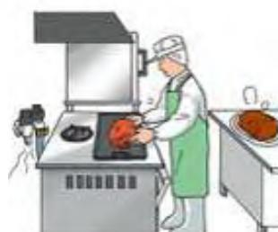
ガスレンジ上方の換気扇を稼動し、ガスの元栓を開け、ガスレンジのバルブも開けて携帯用点火器により点火したところ、爆発が起り、作業者は1か月の入院を要した。
